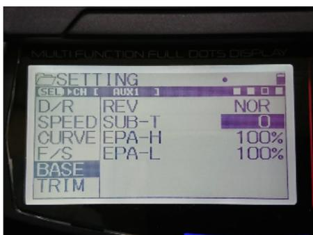
SUB-Tの数値を変更して、LEDマルチライトユニットのハザード(黄色)が点滅する位置に設定して下さい。
